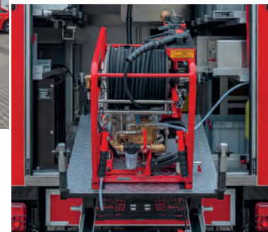
• Heckansicht GR mit Hochdrucklöschgerät HLG WATERJET auf TS DIN Lagerung.
