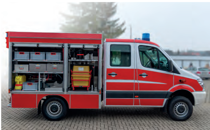
• Gerätewagen VLF auf Mercedes Benz Sprinter 3,50 To. / 4 WD, Aluminiumaufbau mit zwei seitlichen Rollladen mit Drehstangenverschluss.
