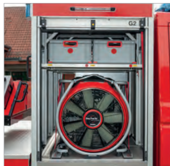
• Lagerung eines Lüfters Leader MT 280 in Winkelschienen.
