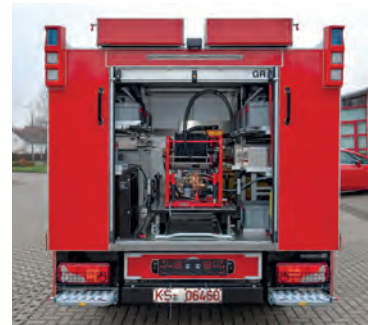
• Heckansicht GR mit Hochdrucklöschgerät HLG WATERJET auf TS DIN Lagerung.
