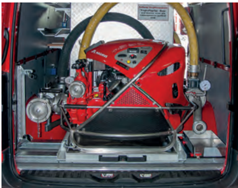
• Lagerung Tragkraftspritze – Quereinbau.
