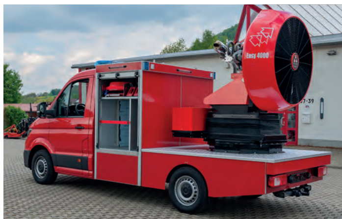
• Trägerfahrzeug VW Crafter 3,5 To. mit Aluminiumaufbau.
