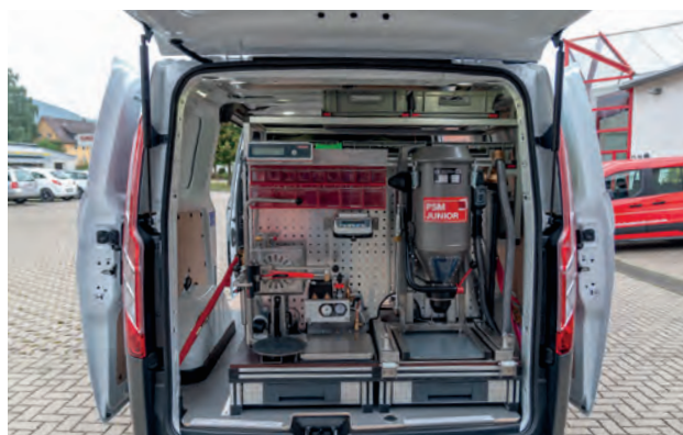
• Mobile Feuerlöcher-Serviceeinheit eingebaut in Ford Transit.
