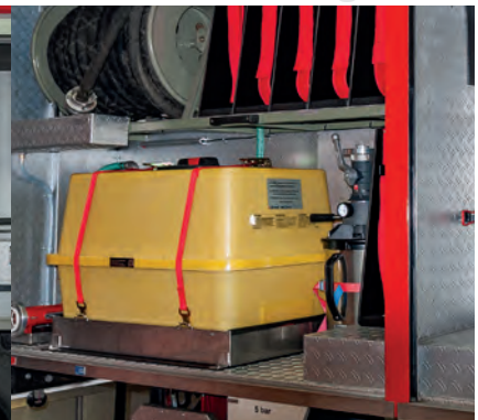
• Wassertanknachrüstung in LF für Hochdrucklöschgerät HLG.
