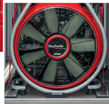
• Lagerung eines Lüfters Leader MT 280 in Winkelschienen.
