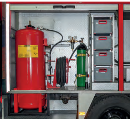
• P250G Feuerlöschernachrüstung in TLF.
